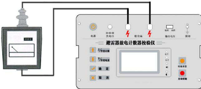
图 2 仪器与待校验设备的接线图
